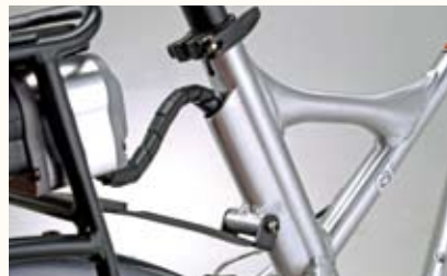
Aufwändiger Rahmen: gebogenes Oberrohr für Schrittfreiheit, auch gut als Tragegriff, Kabelkanal am Sattelrohr
