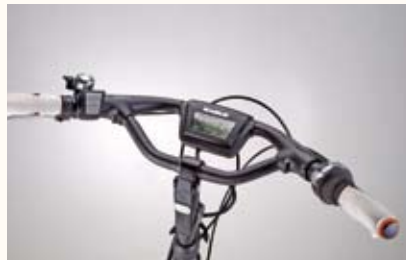
Bügel lenker, verstellbarer Schnellspannvorbau, ergonomische Griffe, neigbares Display, Bedienfeld in Griffnähe
