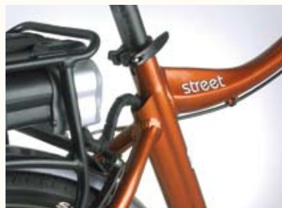
Stark: Kabelverlegung in einem eigenen r-Verlauf
